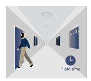
感应器检测不到运动后,自动进入延时时间,延时时间,延时时间后自动关灯。
